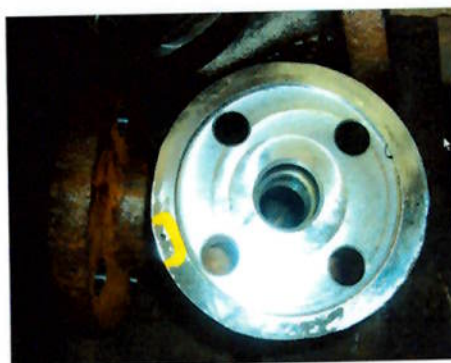
Figura 1 - Ensaio Visual pós-usinagem: Identificação de porosidade
