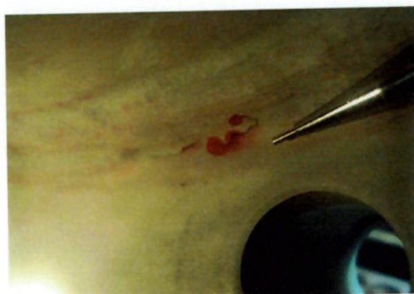
Figura 2 - Ensaio por Líquido Penetrante: Identificação de porosidade
